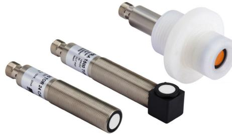
Die Ultraschallsensoren der Serie UPR-A zeichnen sich durch einen grossen Messbereich von max. 1.5m aus und dadurch, dass sie durch den Kunden konfigurierbar sind. Dank der Programmierung von drei verschiedenen grossen Detektionskeulen kann der Sensor vor Ort an die Anwendung angepasst werden. Der Sensor ist sowohl als reiner Näherungsschalter als auch als Distanzsensor mit Analogausgang erhältlich.
